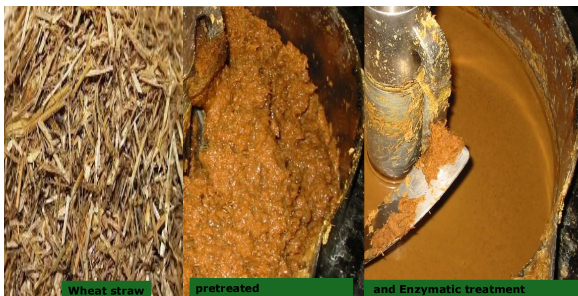
Figuur 6-1 Calciumhydroxide ontsluiting van stro bij 95 °C gevolgd door enzymatische hydrolyse. In het middelste paneel de brij die ontstaat na ontsluiting en het rechter paneel toont chocolademelk achtig resultaat na een Cellulase GC 220 incubatie van het voorbehandelde stro na bijstellen van de pH.
